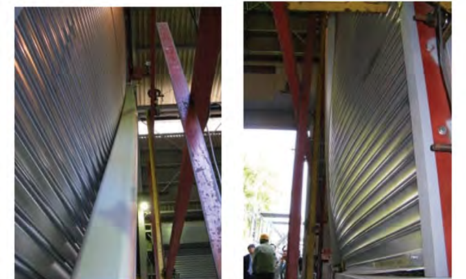
写真 4 補強部材を取り付けたシャッターの耐風圧試験
