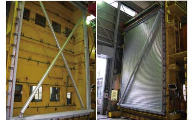
写真 1 シャッター補強部材の取付け状況
