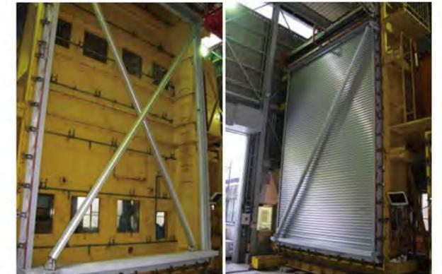
写真 1 シャッター補強部材の取付け状況
